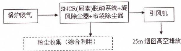
图 5-2 废气治理工艺流程图
